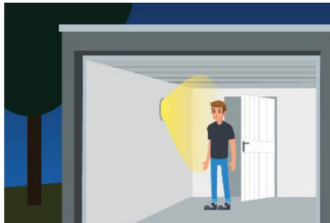
S'il n'y a pas assez de lumière du jour, le capteur allume automatiquement la lumière dès qu'un mouvement est détecté dans la zone de détection du capteur.
